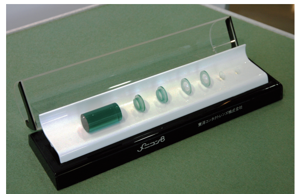
図 4 製品加工説明サンプル 左から、棒材、周辺切削（ツバ付き）、内面切削、外面切削、研磨後のアンカット、エッジ加工前、完成品である。
